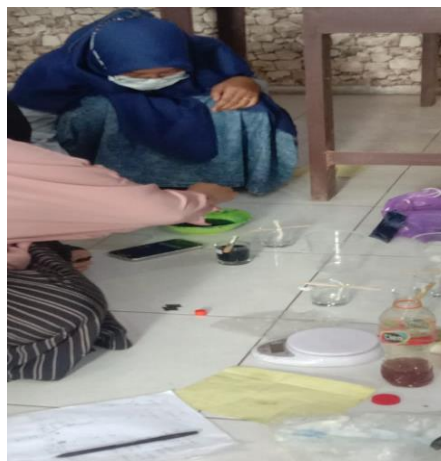
Gambar 4. Penambahan pewarna dan pewangi ke dalam larutan formulasi lilin
