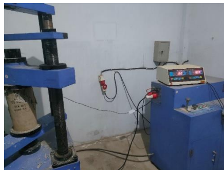
Gambar 6. Pengujian kuat tekan beton menggunakan UTM
