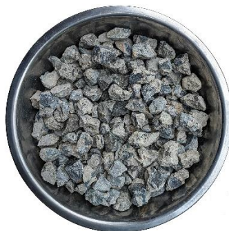
Gambar 3. RCA yang telah dipecah pengganti agregat kasar NA
